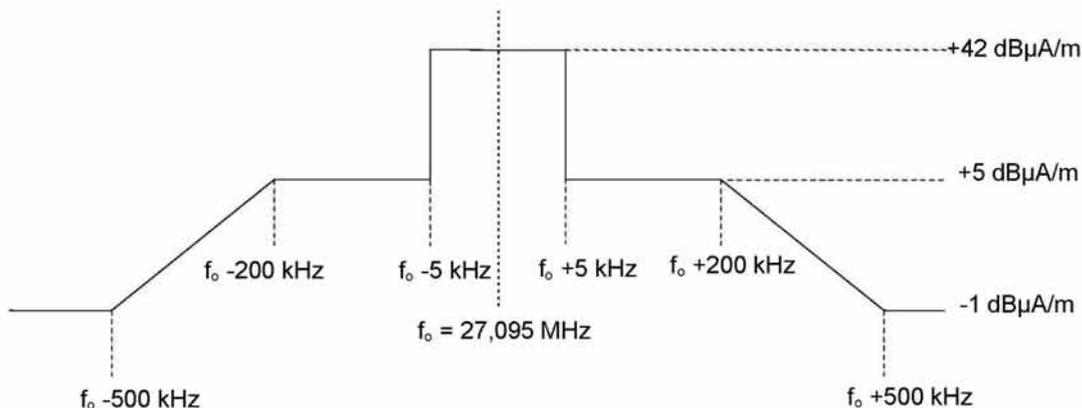
(4) Hodnoty intenzity magnetického pole ve vzdálenosti 10 m pro měřicí šířku kmitočtového úseku 10 kHz pro vysílání v systému EUROLOOP jsou:
