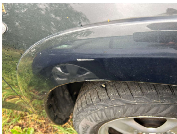
Poškozen levý přední blatník
