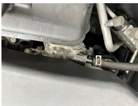
Koroze tělesa vstřikovacího čerpadla, oxidace Al dílů motoru
