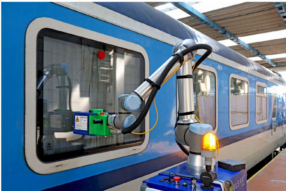
Obrázek 1: Laserová úprava oken, zdroj: ČD
