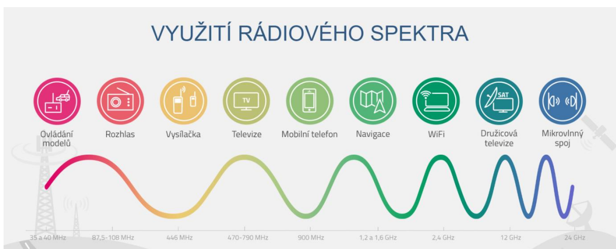
Obr. 2 Využití rádiového spektra z hlediska frekvencí vhodných pro určitou službu [15]
